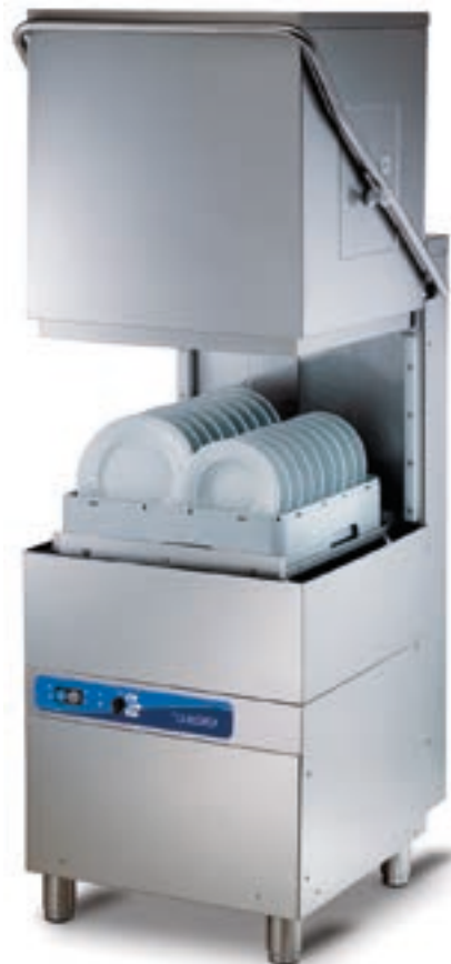
Lavavajillas capota Cesta: 50x50 cm. Ciclos: 90/120/150/180 seg. Producción: hasta 60 cestas/h. Brazos de lavado de acero inox. Dosificadores de líquidos incorporados. Mesas de entrada y salida.
