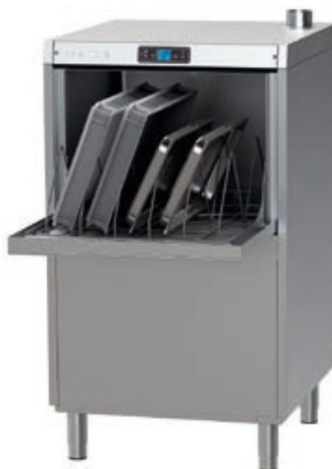
Lavautensilios Cesta: 67x60 cm. Ciclos: 120/240/360/540 seg. Producción: hasta 30 cestas/h. Brazos de lavado de acero inox. Dosificadores de líquidos incorporados.
